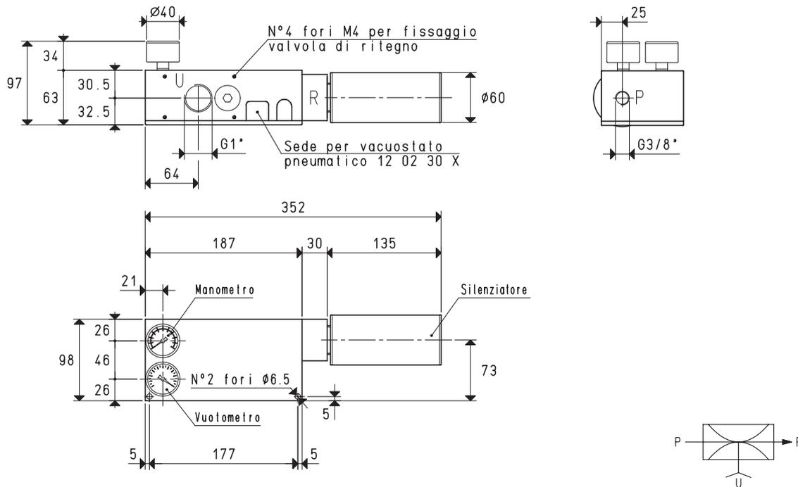
P=CONNESSIONE ARIA COMPRESSA    R=SCARICO    U=CONNESSIONE VUOTO
